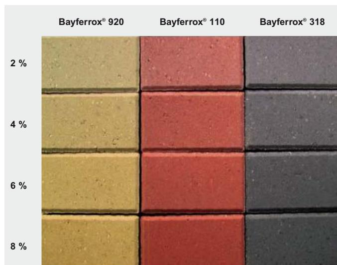
Влияние степени пигментирования на оттенок бетона
