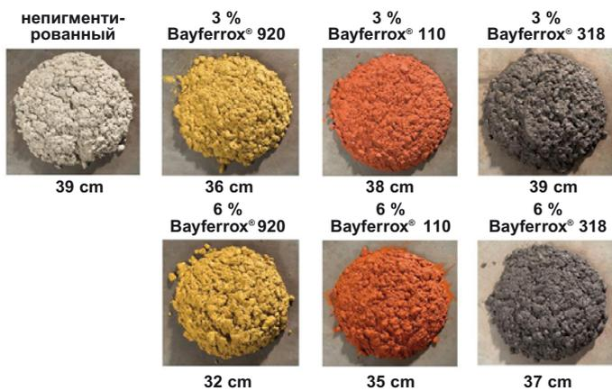
Расплав цементного теста (показатель В/Ц 0,56)
